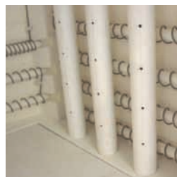
Perforierte Keramikrohre für das Einblasen vorgewärmter Frischluft
