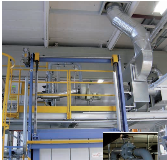
Gasbeheizte Ofenanlage zum Wachsau-schmelzen mit thermischer Nachverbrennung, Programmablaufsteuerung und Temperaturregelung über eine Siemens-SPS S7-313 mit Touch Panel TP 170.
