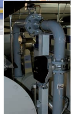
Gasbeheizte Ofenanlage zum Wachsau-schmelzen mit thermischer Nachverbrennung, Programmablaufsteuerung und Temperaturregelung über eine Siemens-SPS S7-313 mit Touch Panel TP 170.
