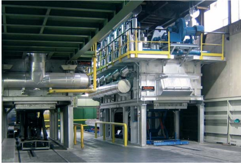
罩式炉，用于铝的扩散退火
