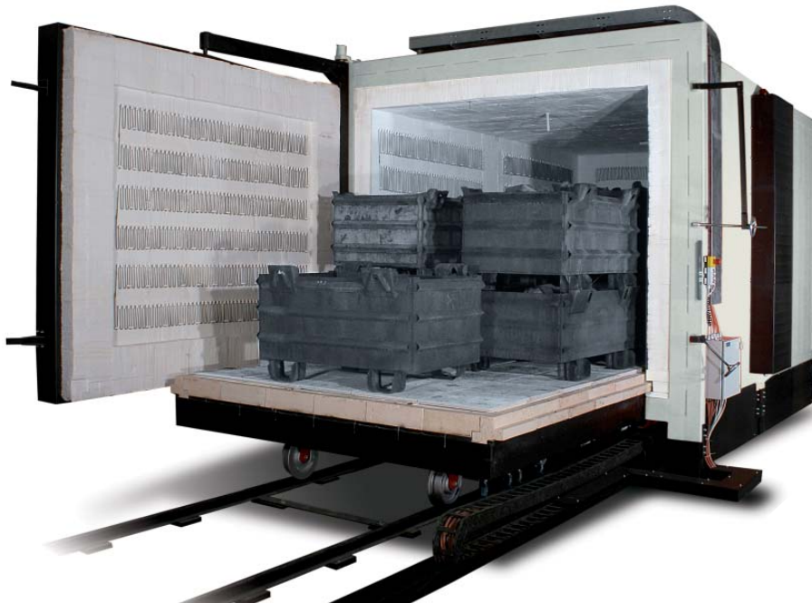
WM 18400/12/S 台车炉，全纤维隔热材料
