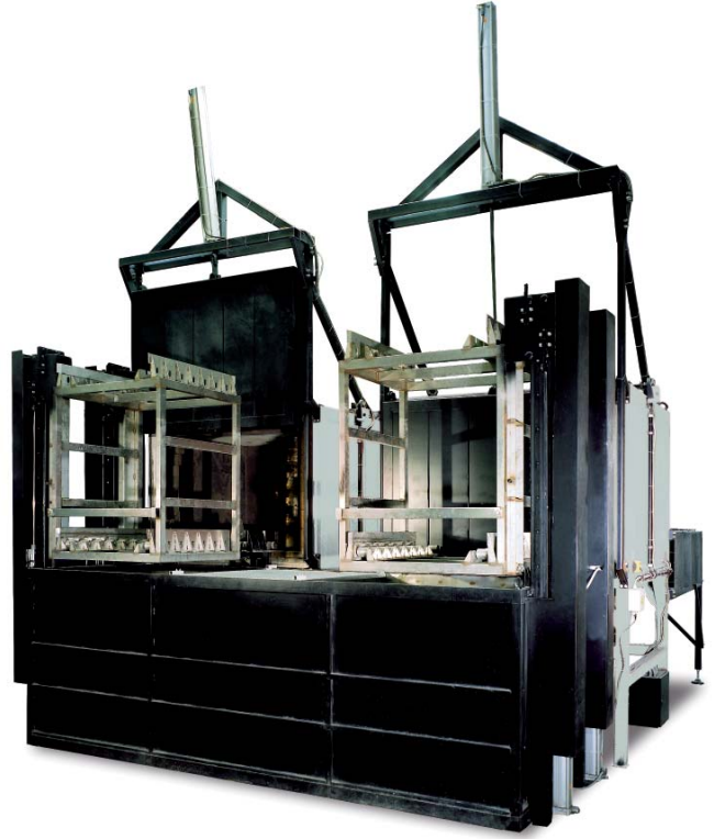
半自动调质设备 由两个箱式炉和对应的淬水槽组成
