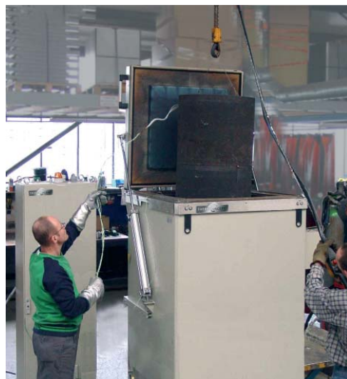
SU 380/06/VA · 装在料篮里的弹簧用退火炉
